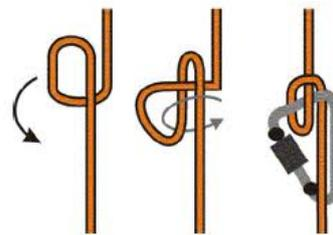
Bild 6: Mastwurf an der Tragkraftspritze
